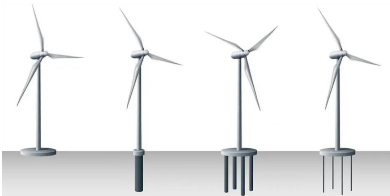
Joonis 2. Tuulikute vundamentide tüübid 4 . Vasakult gravitatsioonivundament, ühevaialine vaivundament ehk monovaivundament, plaatvundament kombineeritud vaiadega, plaatvundament kombineeritud ankrutega.
